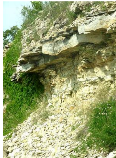
Слика 8.6: Полу-континуално осипање услед деградације стијенског материјала ( raveling )
